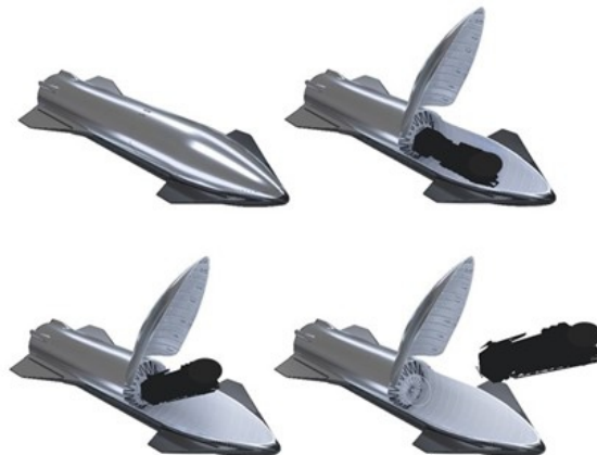
Рисунок 3: Последовательность разворачивания полезной нагрузки Starship
