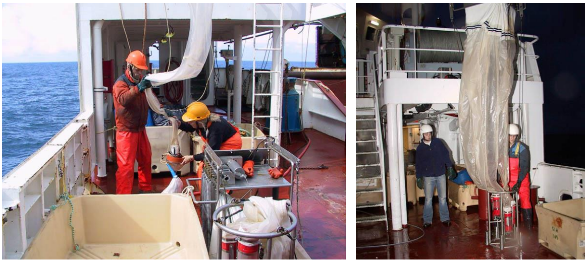
Рис. 4.18. Вид на место для работ с планктонными сетями, справа, в глубине – планктонно-бентосная лаборатория, над ней установлена планктонная лебедка
