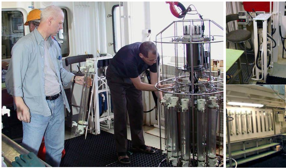
Рис. 4.17. Вид нижнего уровня камеры "CourtYard" (лацпорт в открытом состоянии), справа – рабочее место лебедчика (сверху) и стойка с батометрами (снизу)
