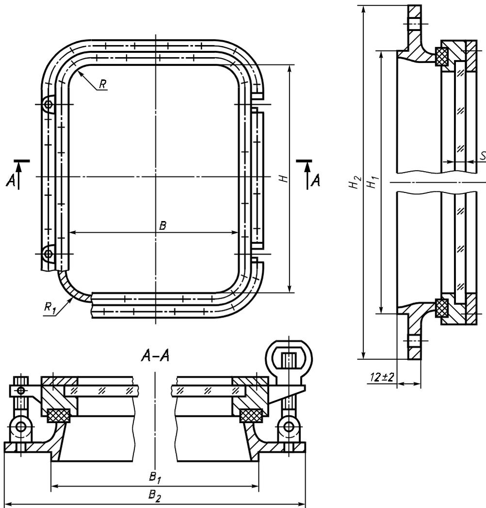
Рисунок 7 — Исполнение JLB (исполнение JRB — зеркальное отражение)
