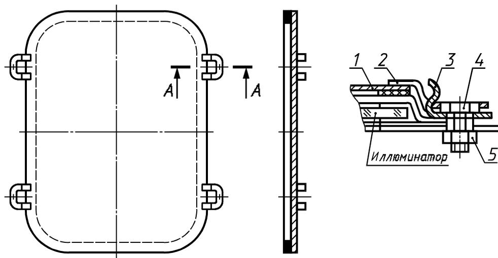
1 — щиток; 2 — прокладка; 3 — защелка; 4 — винт; 5 — гайка
