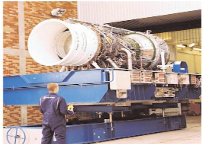
Рис. 4. Корабельный ГТД типа MT-30 фирмы Rolls-Royce
