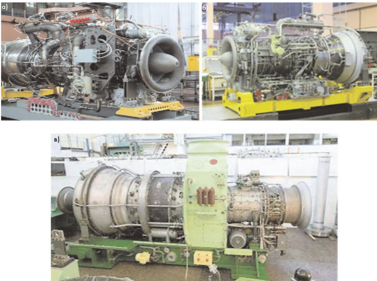
Рис. 1. Мощный ряд отечественных корабельных ГТД: а — М75РУ (5000 кВт); б — М70ФРУ (10 000 кВт); в — М90ФР (20 000 кВт)
