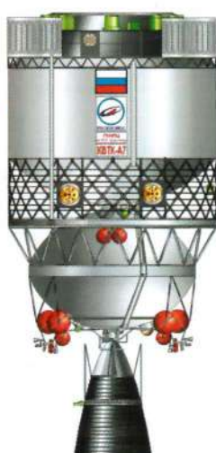
РБ KBTK-A7 для РН 35-тонного класса
