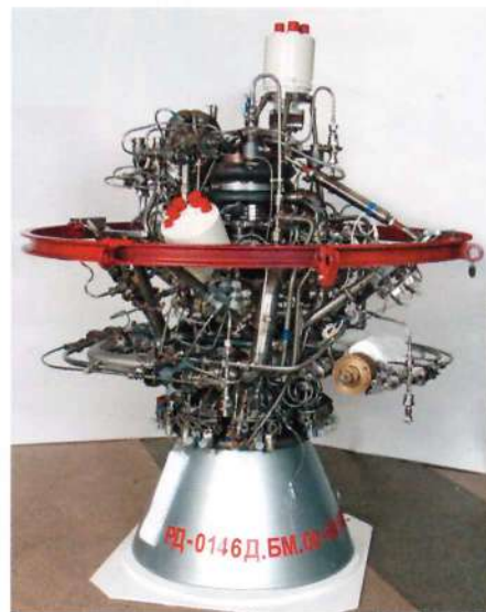
Кислородно-водородный ЖРД РД0146Д является ключевым элементом системы отечественных криогенных разгонных блоков
