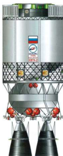
РБ KBTK2 для РН 50-тонного класса
