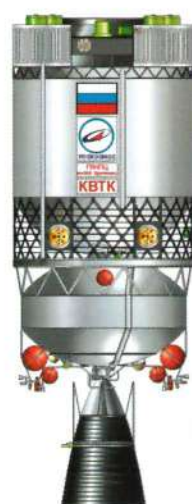
РБ KBTK для РН 20-25-тонного класса
