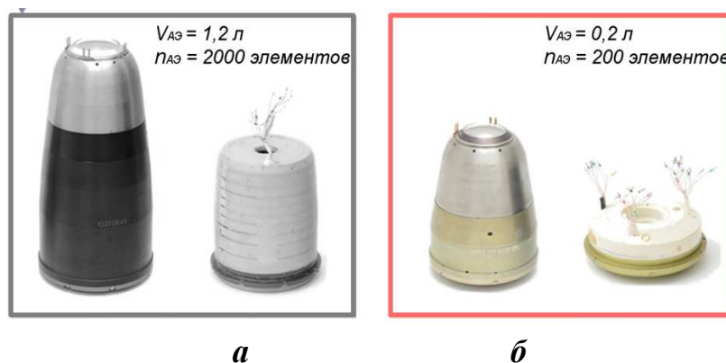
Рис. 7. Сравнение различных вариантов ЛПГС: а – ЛП ГСН и АЭ УАС «Краснополь»; б – ЛП ГСН и АЭ УАС «Краснополь-М2»
