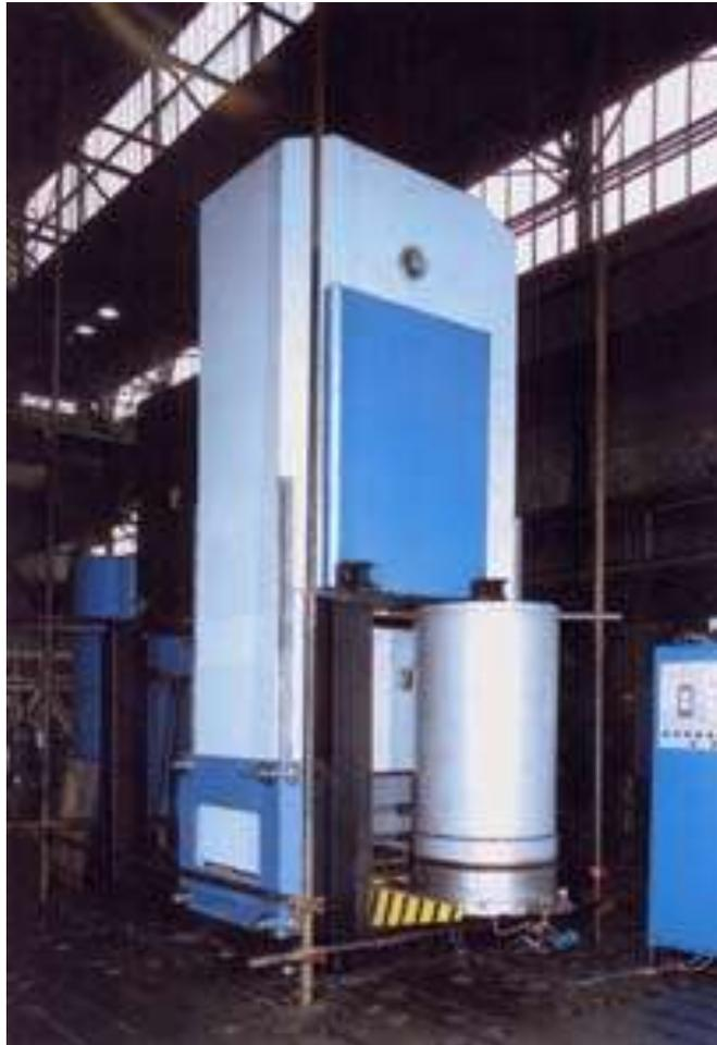
В камере газостата находится стальная заготовка. Начальная температура среды (азот) и детали составляет 1200 С.
