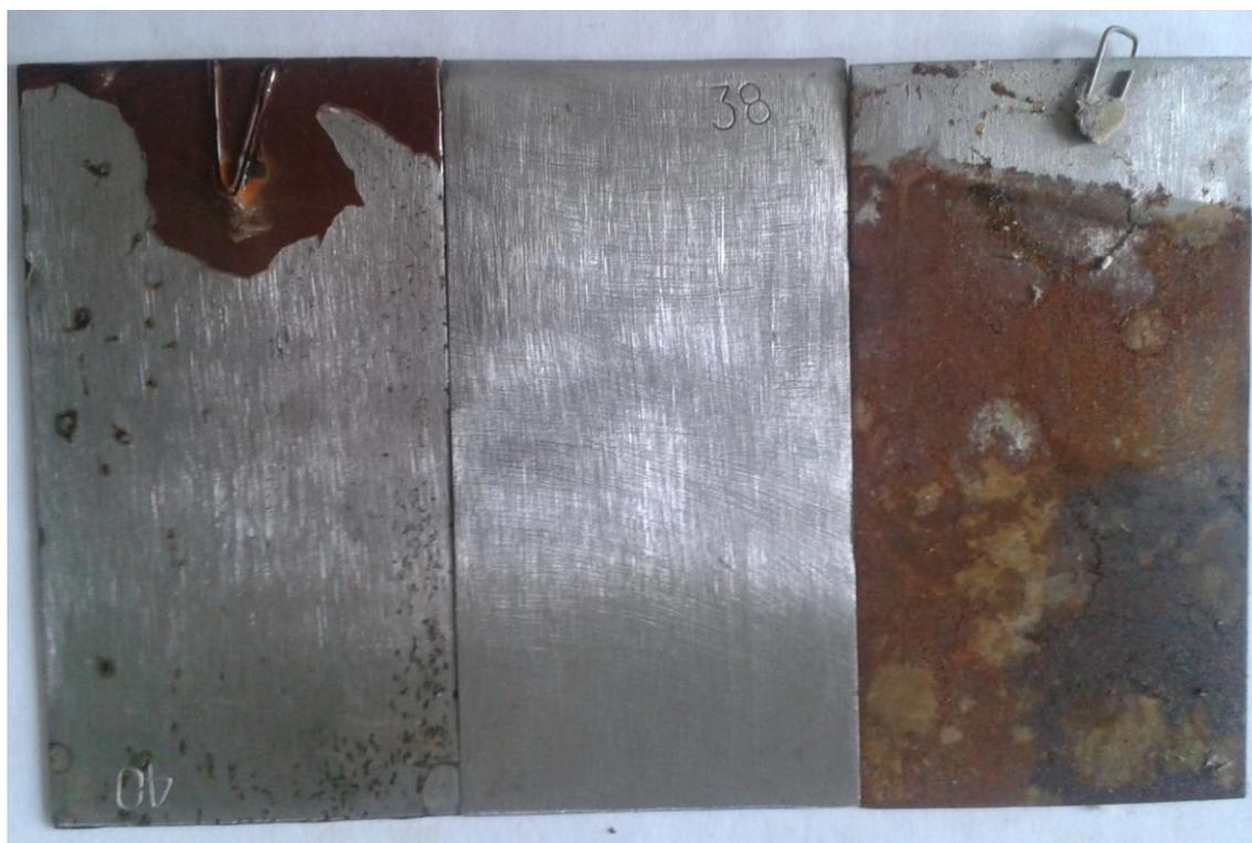
а – образец с пигментированным Пк, после испытаний в течение 90 суток; б – исходный образец без Пк до испытаний; в – образец без Пк после испытаний в течение 2 суток
